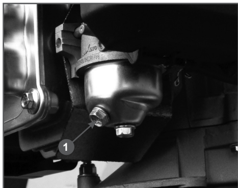
Рис. 19 Сливной болт поплавковой камеры карбюратора
